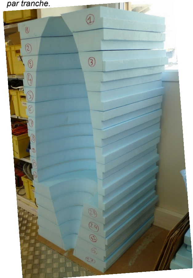
Le moule de la coque supérieure prend forme tranche par tranche.
