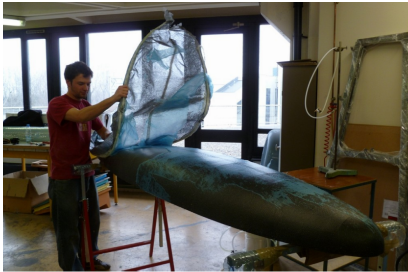
La « mue » après séchage de la résine.
