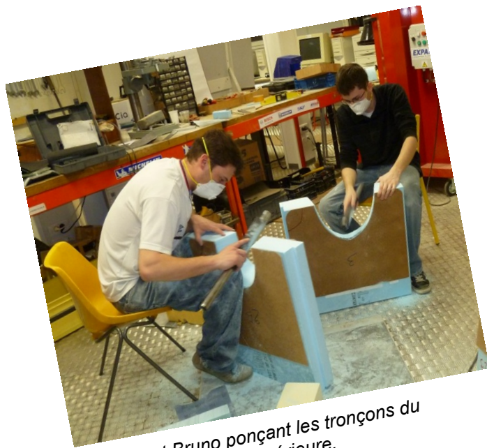
Le moule de la coque supérieure prend forme tranche par tranche.
