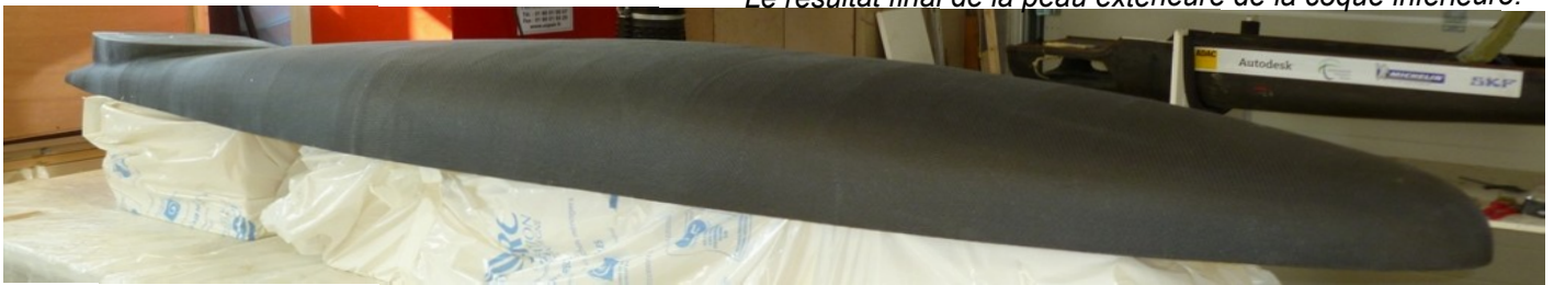
Le résultat final de la peau extérieure de la coque inférieure.
