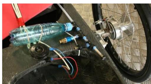
*Le klaxon et la réserve d'air comprimé à leur nouvelle place sur le pont avant.*
