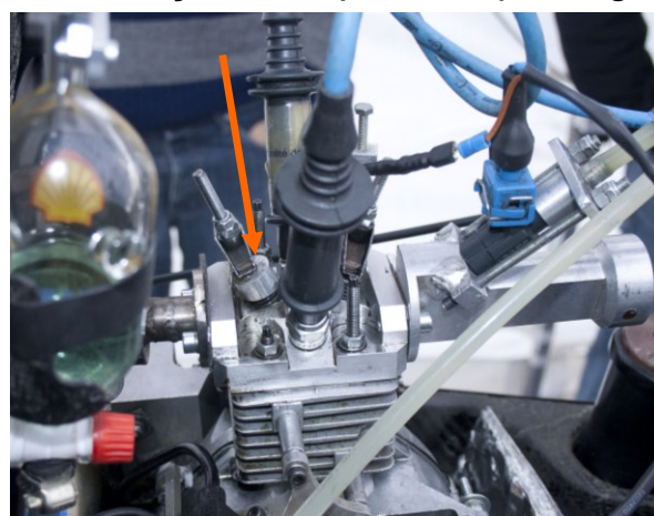
Capuchon réalisé pour augmenter la portée de la soupape sous le culbuteur
