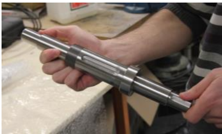
Arbre du banc véhicule usiné par notre partenaire DMI.
