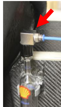
Raccord réservoir usiné par M. Ciszewski
