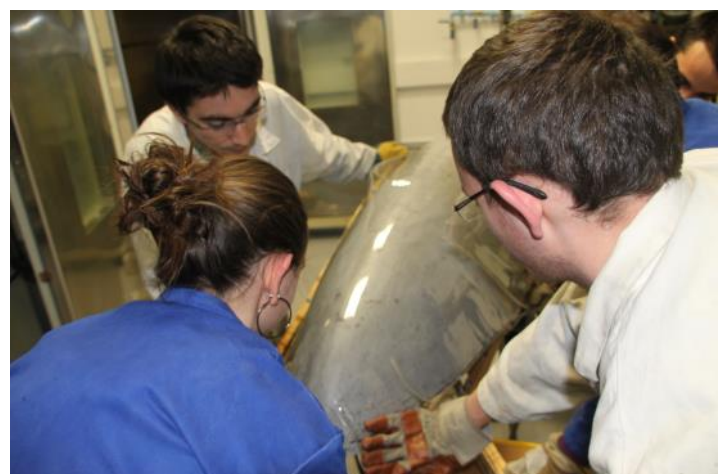
Application du PMMA sur le moule
