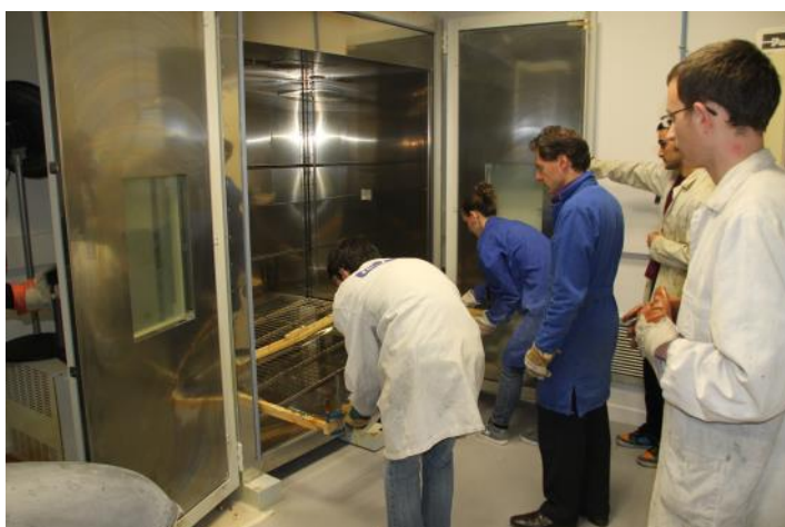
Chauffage de la plaque de PMMA dans l'étuve
