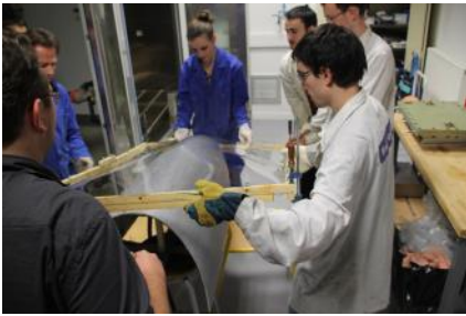
Thermoformage du pare brise
