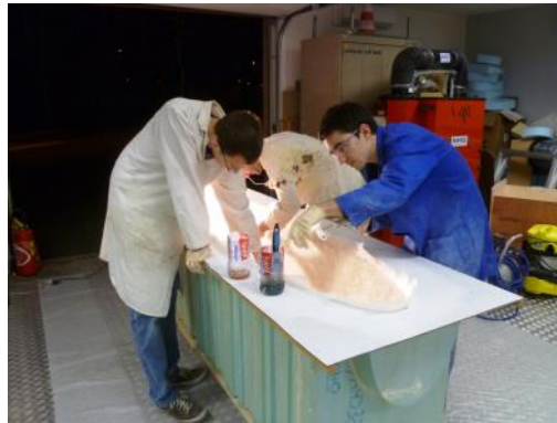
Réalisation du poinçon de thermoformage
